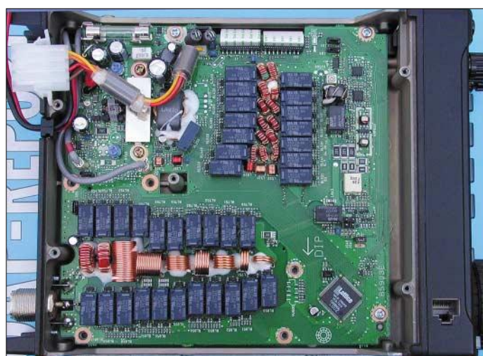
Bild 4: Die HF-Platine auf der Geräteunterseite wird von den beiden, mit Relais umgeschalteten Spulensätzen für Eingangsfilter (mitte) und Antennentuner dominiert.
