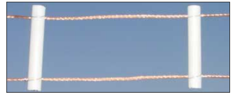
Bild 9: Selbstgebaute Feederleitung Fotos: DK7ZB
