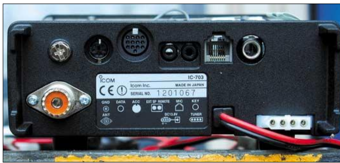
Bild 5: Rückseite des IC-703; die Bedeutung der einzelnen Buchsen lässt sich dem Typenschild entnehmen.
