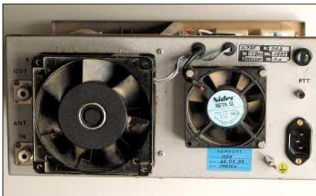
Bild 4: Rückseite mit Lüftern – der linke kühlt die Röhre und der rechte den Netztrafo.
