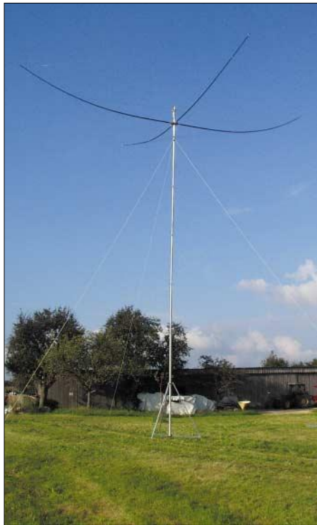
Bild 1: Spiderbeam auf einem 10-m-Aluminium-Schiebemast – dieser kleine Teleskopmast und ein Fernsehrotor sind vollkommen ausreichend. Fotos: DF4SA
